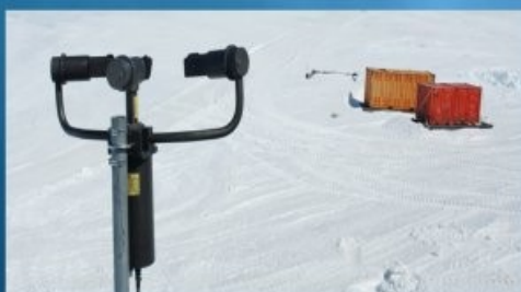
Le biral VPF730 : un disdromètre installé près de la base de Dumont d'Urville
