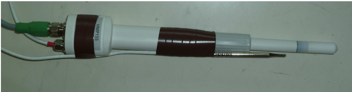
Figure 5 ; HMP155 chauffé avec sonde de température externe.
