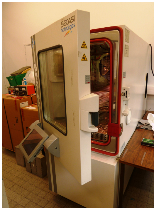
Figure 4 : chambre froide SECASI ST 340
