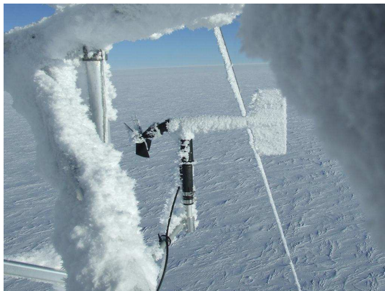
Figure 2 : Anémomètre endommagé, Dôme C, Antarctique
