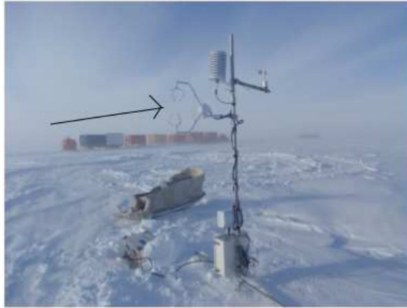
FIGURE 6: Anémomètre sonique à Dôme C indiqué par une flèche
